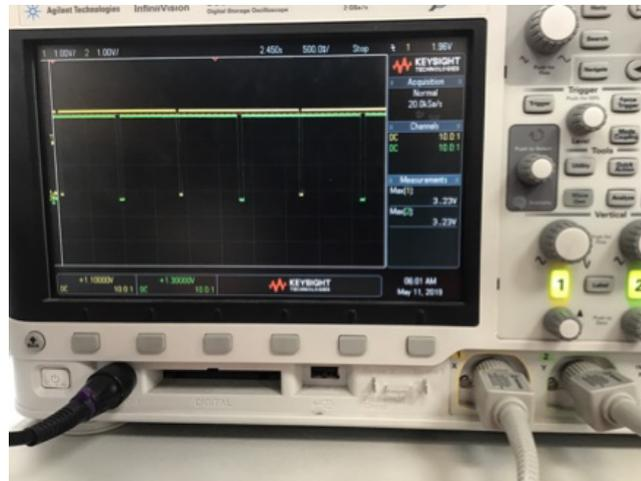
Cuando se completa su período, el canal 1(SW2) recibe un 0 lógico y cuando se completa la mitad del periodo, se recibe un 0 en el canal 2 (SW1) indicando a la araña que la otra pata debe avanzar.
